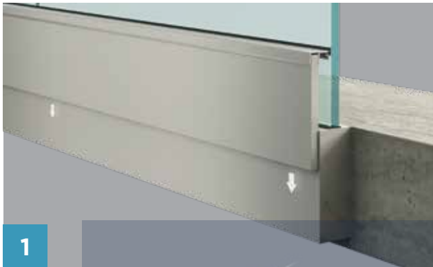
1 Τοποθέτηση του προφίλ επικάλυψης / Placing the top cover profile
