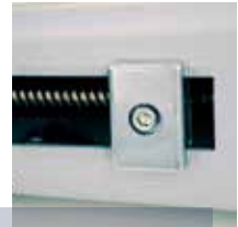
Μηχανικός ρυθμιστικός διακόπτης. Mechanical limit switch.
